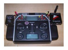
El cable con 3 hilos(-+ signal) que viene con el **STICKPLUS** lo conectaremos a los puertos **DATA** y **DSC**. El negativo y positivo al **DATA** usando un conector de servo **JR**, y el negativo y signal al **DSC** mediante un **JACK mono**. En nuestro caso el puerto **DATA** también lo usamos para conectar un DRAGONLINK V2 por lo que usamos una "Y" para conectar ambos dispositivos.
