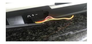
El **STICKPLUS** trae solamente un joystick con 2 canales y un par de pulsadores que gobiernan un tercer canal. Nosotros añadiremos un potenciómetro y un conmutador de 6 posiciones conectándolo en la parte posterior de la placa. Soldamos los cuatro hilos a la placa, positivo y negativo y los 2 canales. Los conectaremos al potenciómetro de 10k y al circuito compuesto por las 5 resistencias de 3k3 y el conmutador de 6 posiciones.
