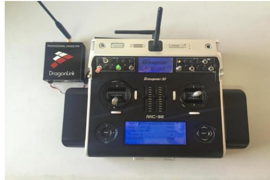
Este procedimiento es compatible con todos los modelos de emisores de DRAGON LINK, en este caso hemos utilizado un dragon link V2. Primeramente conectamos el modulo emisor al puerto para módulos externos: **EXT.PPM**. De los 4 hilos que usa este conector solo usaremos 3 (-, + y PPM) y dejaremos el primer hilo de la izquierda sin conectar.
